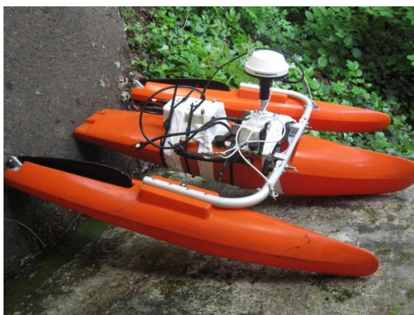
Photo 1: ADCP et GPS sur trimaran
