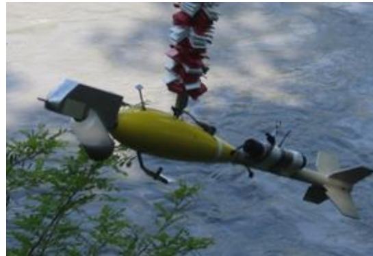
Photo 5 : Préleveur OFEV monté sur saumon
