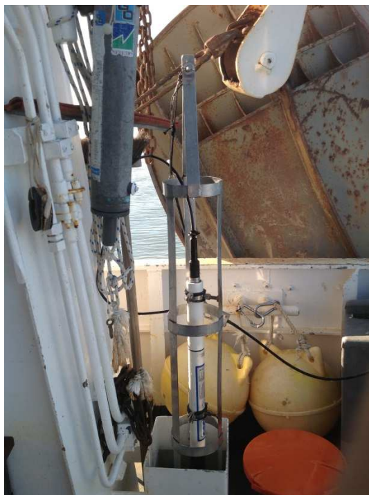
Figure 11. La sonde multiparamètres Hydrolab
