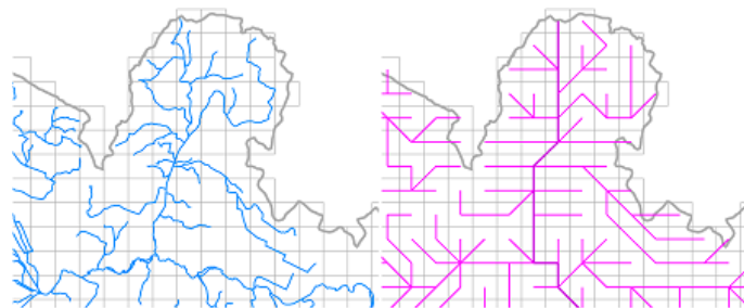
Figure 8 : Exemple du réseau hydrographique numérique (gauche) et du schéma de routage du modèle (droite).
