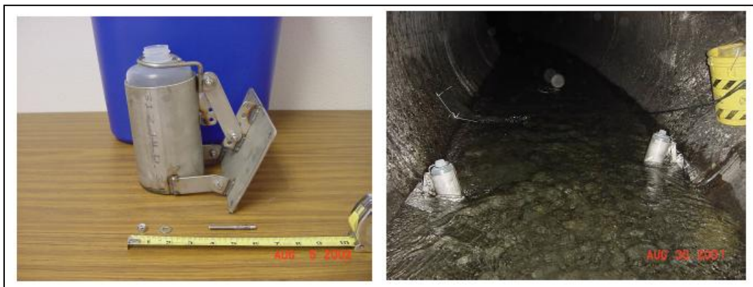
Figure 13 : Illustration du déploiement de pièges à particules dans les réseaux canalisés (Fuller et al., 2009)
