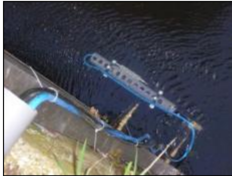
Figure 8 : Exemple de piège à particules et conditions de déploiement sur la Samme à Ronquières (photo ISSeP)
