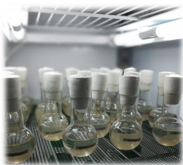
Figure 6: Ballons de 100 ml dans l'armoire thermostatée (culture + milieu Dauta)
