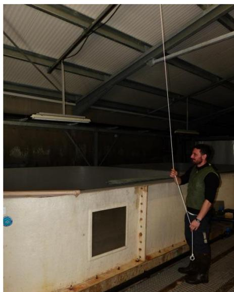
**Figure 1** : Système de rail pour le déplacement du luminaire (Sturio 1) (© Ph Jatteau - Irstea)
