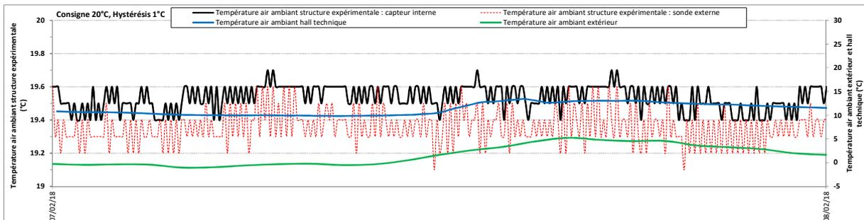
figure 13 : Evolution de la température le 7/2/18 (Consigne : 20°C, Hystérésis 1°C)
