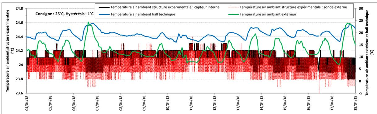
figure 18 : Evolution de la température du 4/4 au 18/4/18 (Consigne : 25°C, Hystérésis 1°C)
