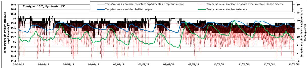
figure 16 : Evolution de la température du 2/3 au 13/3/18 (Consigne : 15°C, Hystérésis 1°C)
