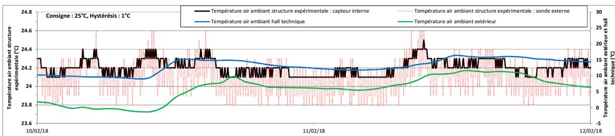
figure 14 : Evolution de la température du 10/2 au 12/2/18 (Consigne : 25°C, Hystérésis 1°C)
