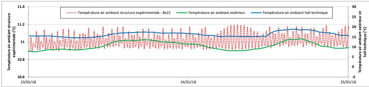
figure 11 : Evolution de la température du 23/1 au 25/1/18 (Consigne : 10°C, Hystérésis 2°C)
