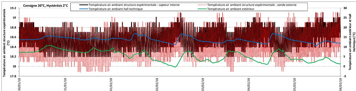
figure 12 : Evolution de la température du 30/1 au 6/2/18 (Consigne : 20°C, Hystérésis 2°C)
