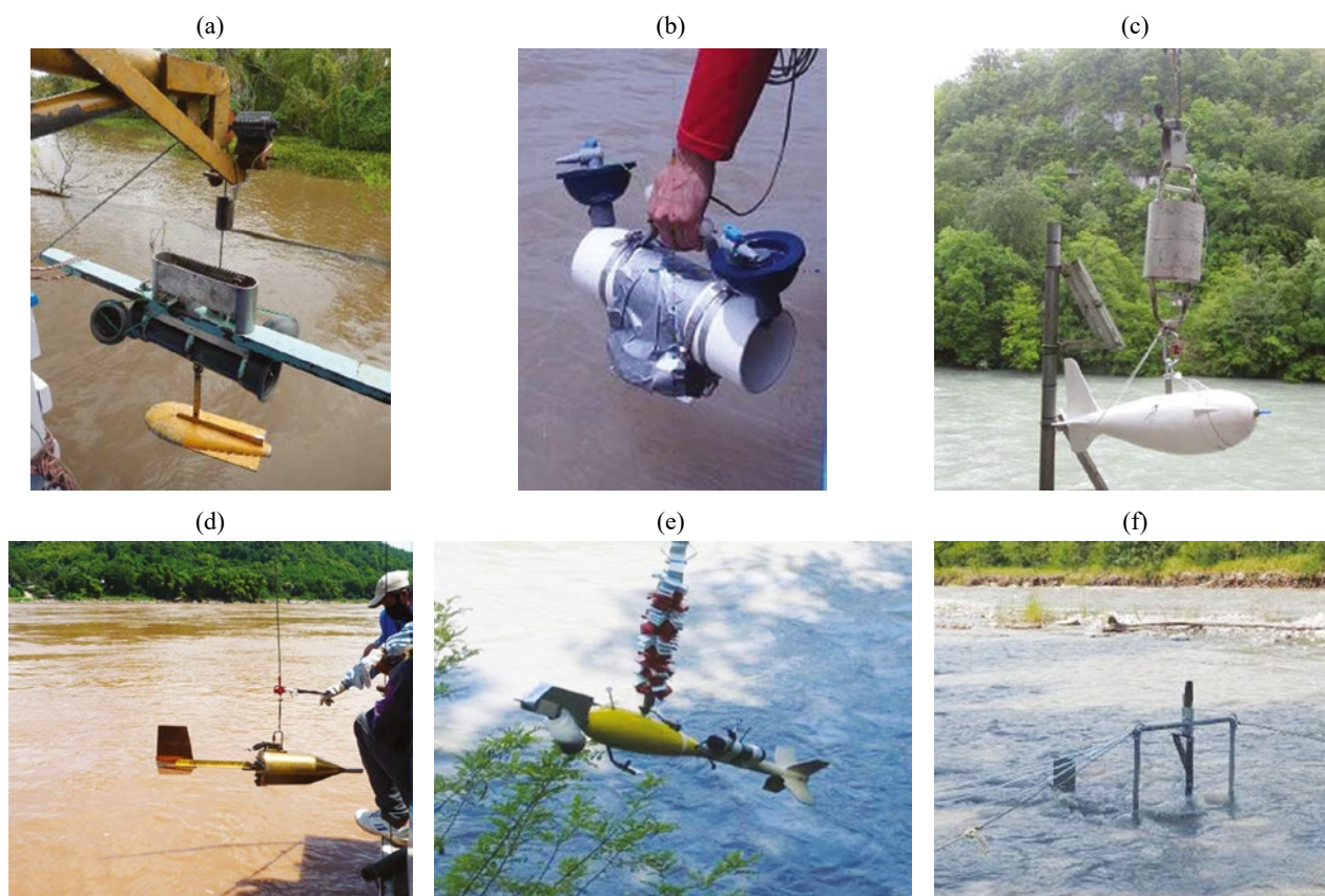
Figure 1 : Différents types de préleveurs déployés par les auteurs et en collaboration avec la CNR, l'équipe de l'observatoire HyBAM, l'IRD, le Cerege, l'OFEV : (a) Préleveur type Callède (capacité 8L) déployé sur l'Amazone en 2014, (b) Préleveur manuel type Niskin (2L) déployé sur la Saïgon River en 2016, (c) P72 (0,5L) déployé depuis la traîlle de Bognes sur le Rhône en 2016, (d) Préleveur de sable intégratif type Delft déployé sur le Mékong en 2013, (e) Préleveur automatique de l'OFEV (1L) déployé aux Rippes sur le Rhône en 2016, (f) Préleveur multiprofondeur par pompage déployé sur l'Arc en Maurienne en 2017.
