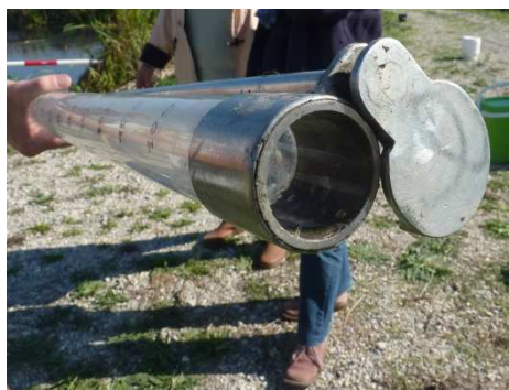
Photo 2 : Canne de prélèvement utilisée pour la bathymétrie
