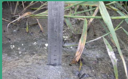
Mesure de la hauteur des boues accumulées
