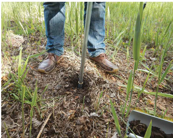
Figure 6. Prélèvement d'un échantillon de sol.
