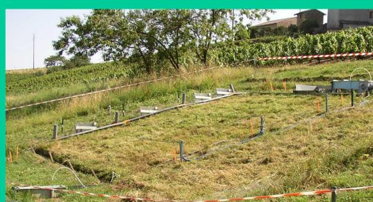
La zone instrumentée mesure 4 m sur 6 m. La pente (20%) et le couvert sont globalement uniformes.
