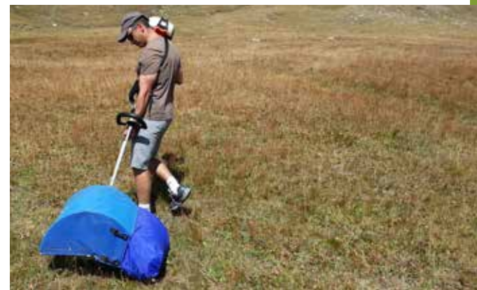
Figure 4 : Brosseuse portative, modèle Hand Held Seed Harvester (produite par Prairie habitats, Canada)
