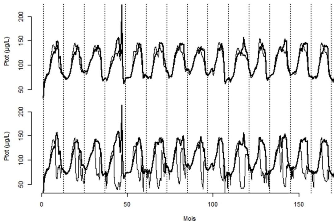
**Figure 10.** Concentration en phosphore modélisée dans la retenue de Villerest (VIL42) avec le modèle LakeMab après changement des forçages de température et de débit, prise en compte de concentrations variables dans les tributaires avec la méthode de segmentation, ajustement du niveau de sortie de l'eau par le barrage, effet du marnage et prise en compte de la température des tributaires pour diriger les apports vers la couche de surface ou celle du fond.
