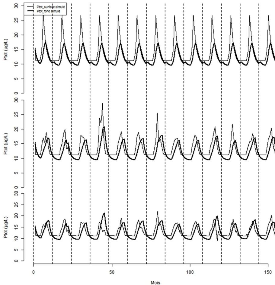
**Figure 4.** Concentration en phosphore modélisée dans le lac de Chailloux (LDC25) avec le modèle LakeMab de base (haut), après remplacement du sous-modèle de température (milieu) et après ajout des débits mensuels mesurés (bas).
