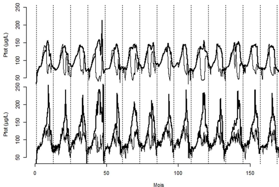
**Figure 12.** Concentration en phosphore modélisée dans la retenue de Villerest (VIL42) avec le modèle LakeMab après changement du forçage de température, prise en compte de concentrations variables dans les tributaires avec la méthode de segmentation, ajustement du niveau de sortie de l'eau, simulation de l'effet du marnage, prise en compte de la température des tributaires et utilisation de débits à fréquence mensuelle (haut) et journalière (bas).
