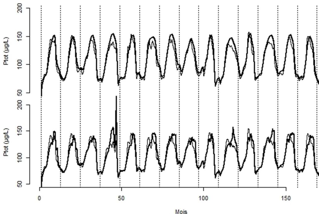
**Figure 9.** Concentration en phosphore modélisée dans la retenue de Villerest (VIL42) avec le modèle LakeMab après changement des forçages de température et de débit, prise en compte de concentrations variables dans les tributaires avec la méthode de segmentation, ajustement du niveau de sortie de l'eau par le barrage et sans (haut) et avec (bas) simulation de l'effet du marnage.
