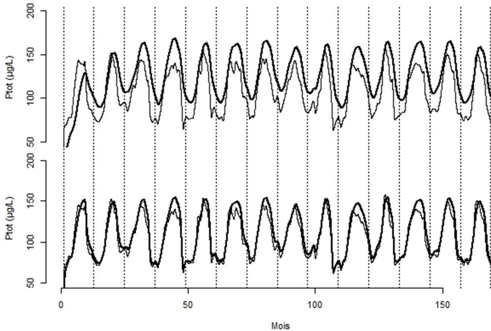
**Figure 8.** Concentration en phosphore modélisée dans la retenue de Villerest (VIL42) avec le modèle LakeMab après changement des forçages de température et de débit, prise en compte de concentrations variables dans les tributaires avec la méthode de segmentation et en considérant une sortie de l'eau uniquement par la surface (haut) ou par le fond.
