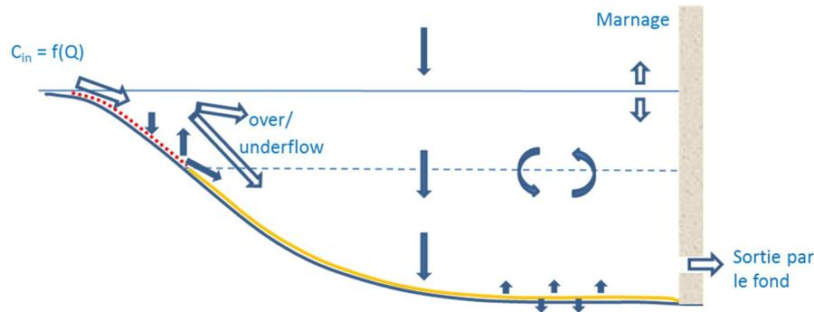
**Figure 11.** Schéma présentant les quatre principales améliorations apportées au modèle LakeMab : la modulation de la concentration dans les tributaires en fonction du débit, l'entrée par la surface ou le fond de l'eau des tributaires selon sa température, la prise en compte du marnage du plan d'eau et la possibilité pour l'eau de sortir par une vanne de fond (cas des retenues).
