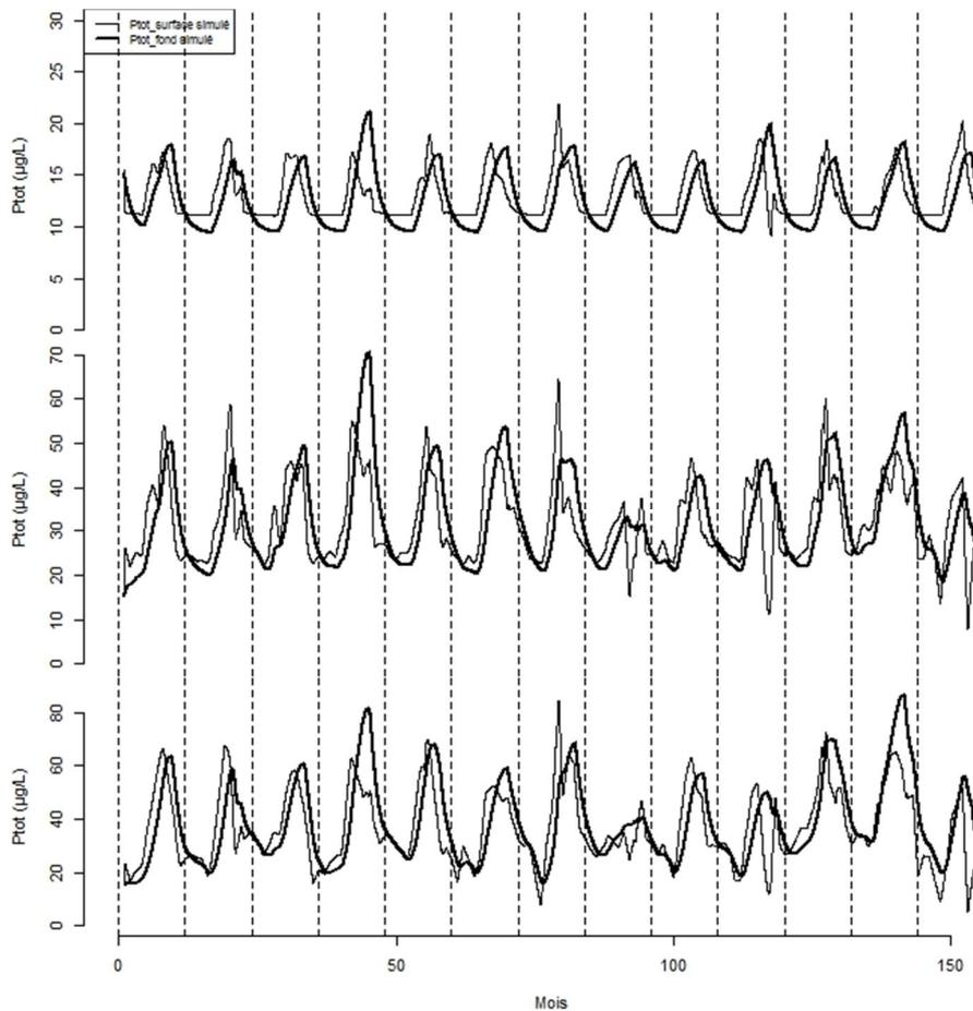
**Figure 7.** Concentration en phosphore modélisée dans le lac de Chaillexon (LDC25) avec le modèle LakeMab après changement des forçages de température et de débit (haut) et avec prise en compte de concentrations variables dans les tributaires avec la méthode de segmentation (milieu) et la méthode quick flow-base flow (bas).
