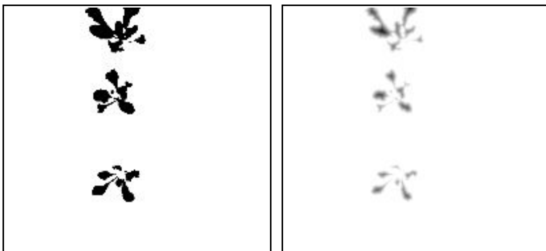
FIGURE 12: Utilisation de distanceTransform pour obtenir la carte de distance (droite) à partir d'une image binaire (gauche)
