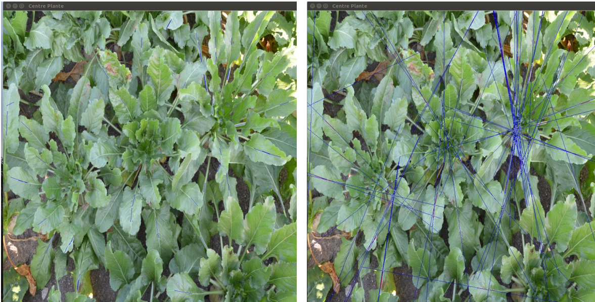
FIGURE 29 : Lignes trouvées par la fonction HoughLines (gauche) et lignes étendues (droite)
