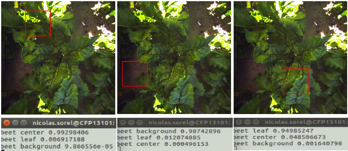
FIGURE 18 : Exemple de résultat utilisant le modèle créé et les fonctions tensorflow sur différentes parties d'une image de betterave
