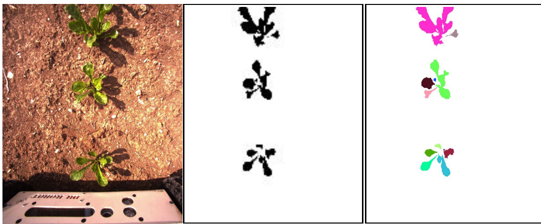
FIGURE 10 : Utilisation de connectedComponents pour obtenir une image labellisée (droite) à partir de l'image binaire (milieu) d'une photo de betterave (gauche)
