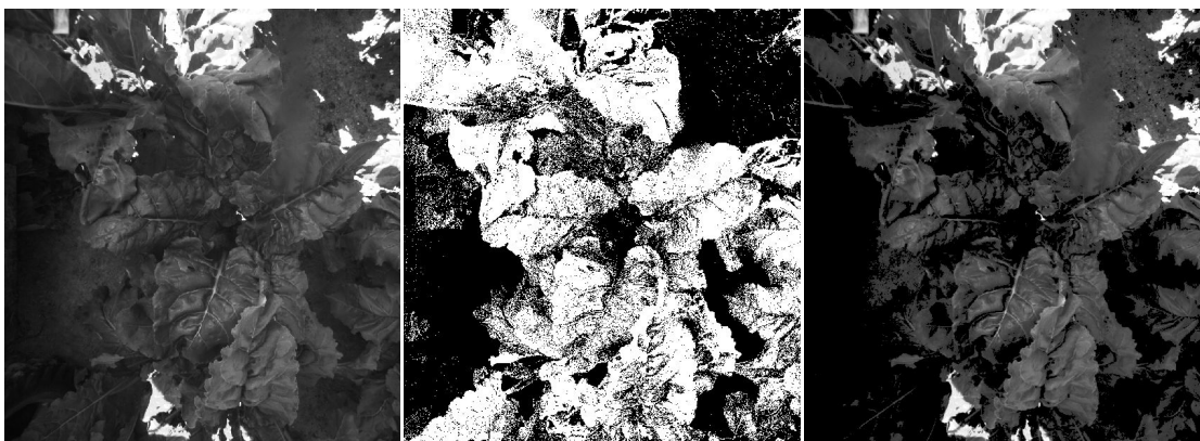
FIGURE 8 : Utilisation de threshold pour binariser (milieu) ou seuiller à zéro (droite) une image en niveaux de gris (gauche)
