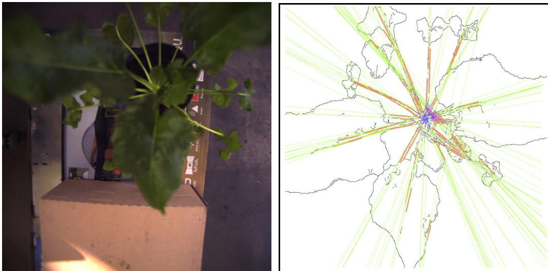
FIGURE 11 : Utilisation de HoughLines pour trouver des lignes sur une plante
