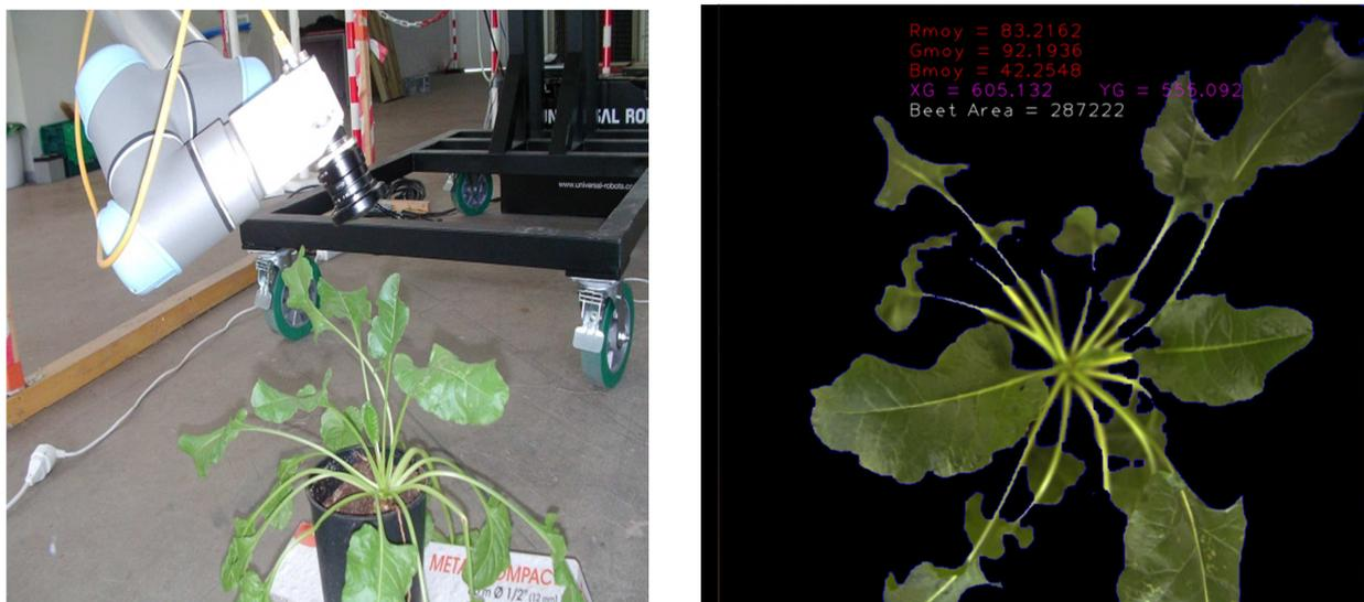
Figure 13 - Détection des feuilles de betteraves par traitement d'image
