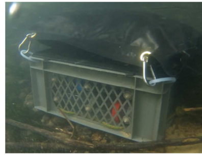
Système d'immersion contenant les cages de gammare
