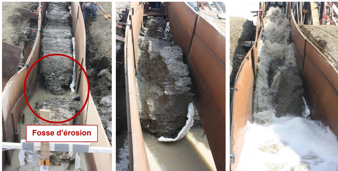
Figure 23 : Photos de la fosse d'érosion, localisée en bas de la pente. Sol non traité, source : IRSTEA
