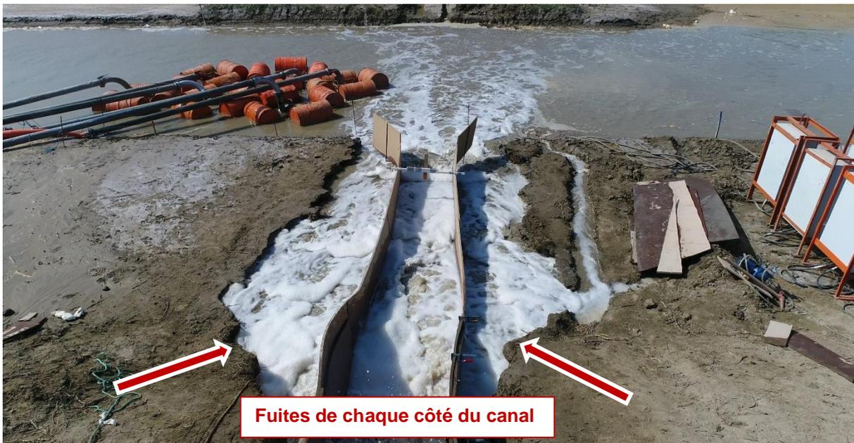
Figure 24 : Digue en sol non traité, lors du dernier test d'érosion, source : le SYMADREM
