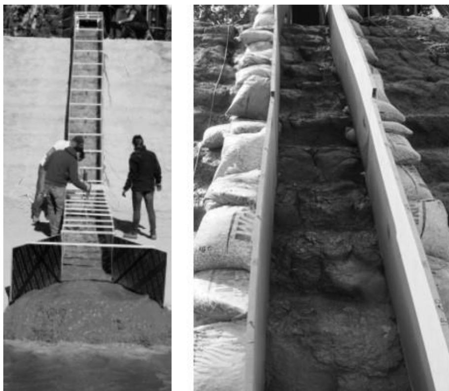
Figure 28 : Digue érodée lors des essais de surverse de 2017, source : IRSTEA
