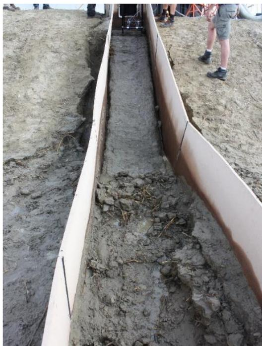
Figure 21 : Essai n°1 sur sol non traité. Départ de la terre végétale et accumulation en aval, source : IRSTEA
