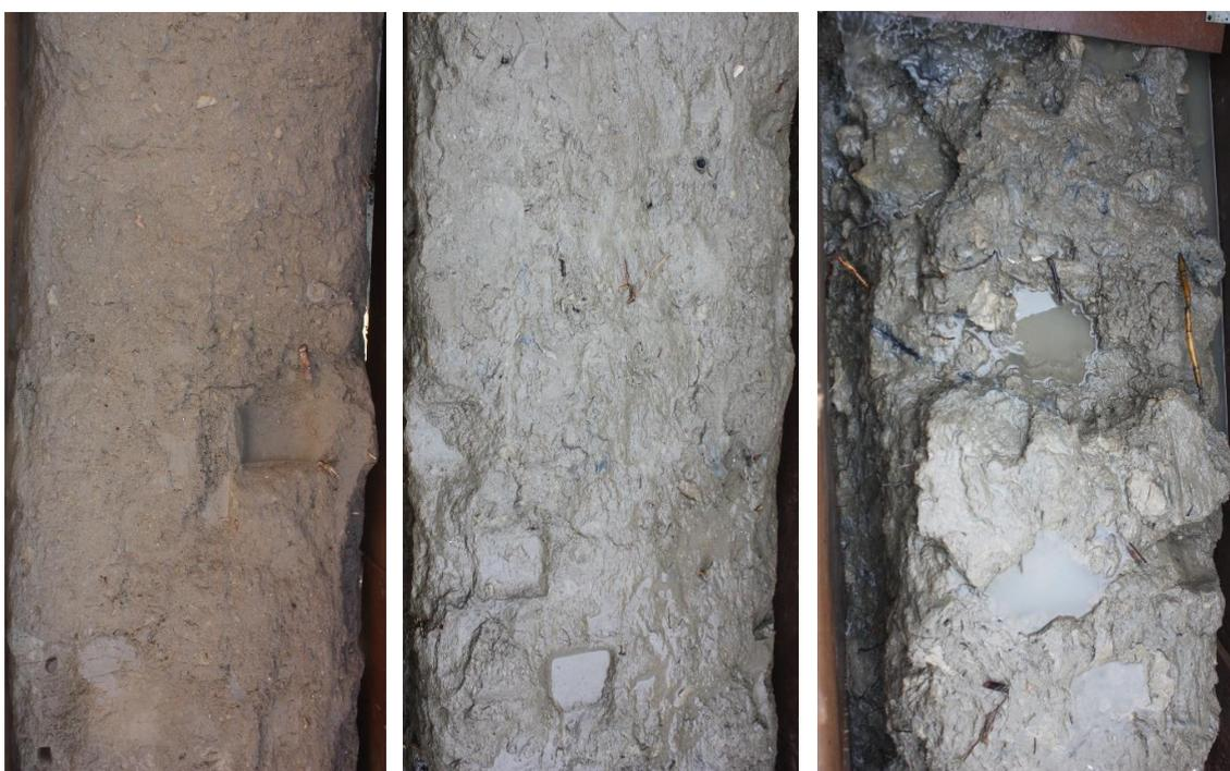
Figure 22 : De gauche à droite : Sol LB50, sol chaux, sol non traité. Photos prises sur la crête à la fin des 10 essais, source : IRSTEA
