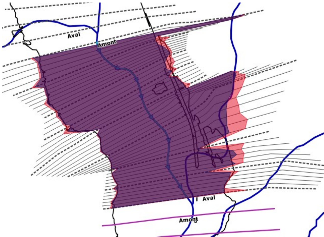
Figure 11. Résultat initial pour le tronçon T2 avec la méthode M3 (ligne délimitant la crue connue, reconstitution de la crue connue en violet, crue extrême en rouge).
