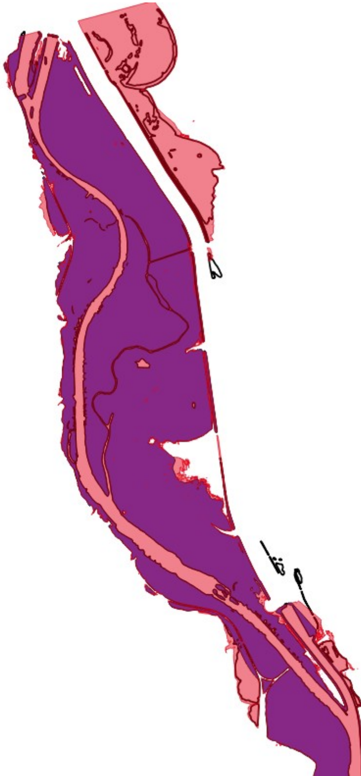
Figure 3. Comparaison de la crue extrême calculée avec Surcotes (rouge) avec la crue millénaire préalable (bleu) sur le tronçon T1, le trait noir délimitant la crue connue préalable.
