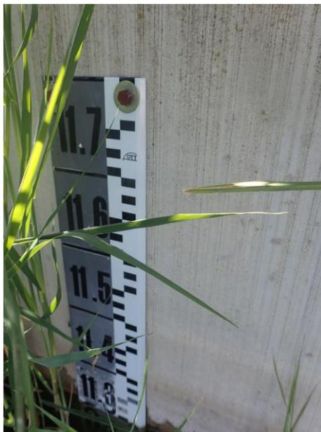
Figure 3 : exemple d'échelle limnimétrique (photographie : J. Dublon)
