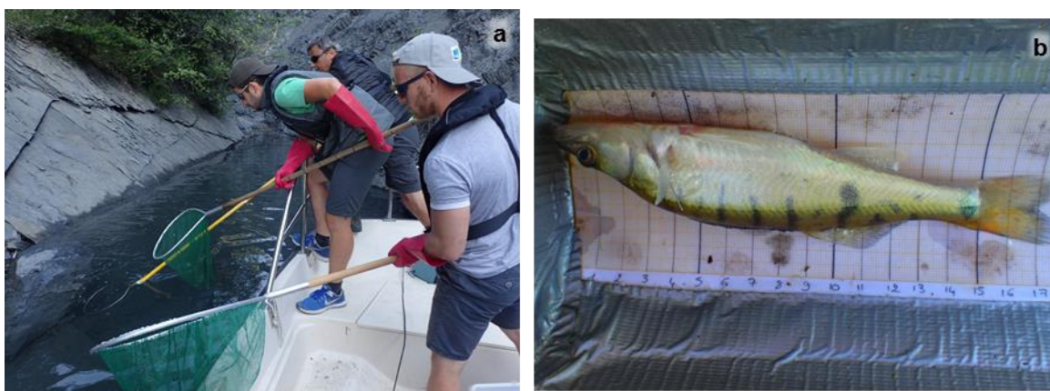
Figure 6 : pêche électrique en plan d'eau, prospection (a) à pied et biométrie (b) (ici, mesure de la taille) (Photographies : J. Dublon)
