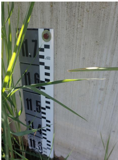
Figure 3 : exemple d'échelle limnimétrique (photographie : J. Dublon)
