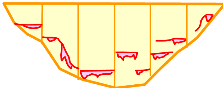
Figure 56 : Fissures horizontales calcifiées de pied des consoles – parement aval
