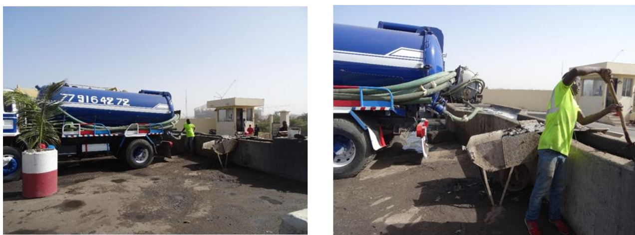
Figure 13 Dépotage des boues d'un camion de vidange sur la station de Pikine
