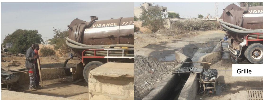
Figure 10 Dépotage des boues d'un camion de vidange sur la station de Rufisque Nord
