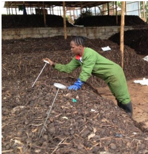
Figure 91 Photo d'un opérateur qui contrôle l'humidité et la température d'un andain
