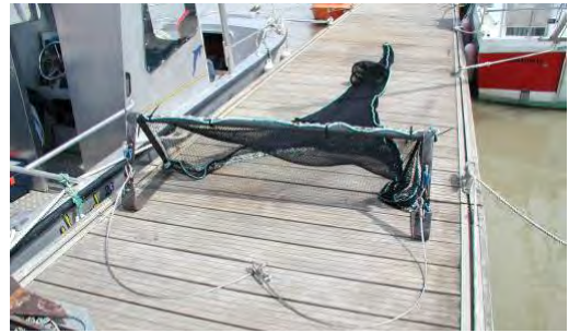
Figure 3 : Chalut à perche de 1m50
