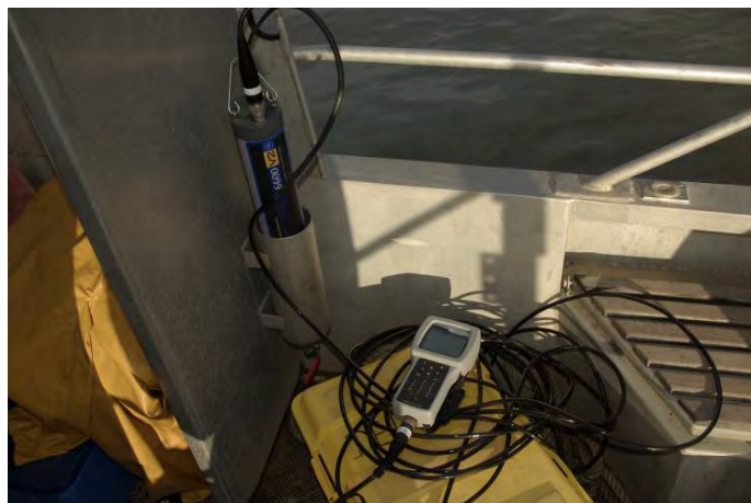
Figure 5 : Photo de la sonde multi-paramètres et du boîtier de lecture de surface. (© Photos Collection Irstea)
