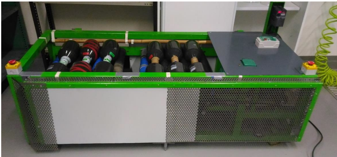
Photo 1 – Dispositif d'agitation pour enrichissement des sédiments par des substances chimiques
