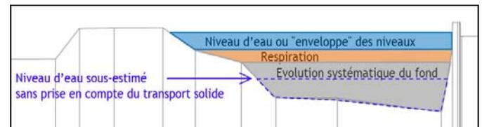
FIGURE 1 : ILLUSTRATION DE L'ESTIMATION DU NIVEAU ATTEINT EN CRUE AVEC CHARRIAGE.
