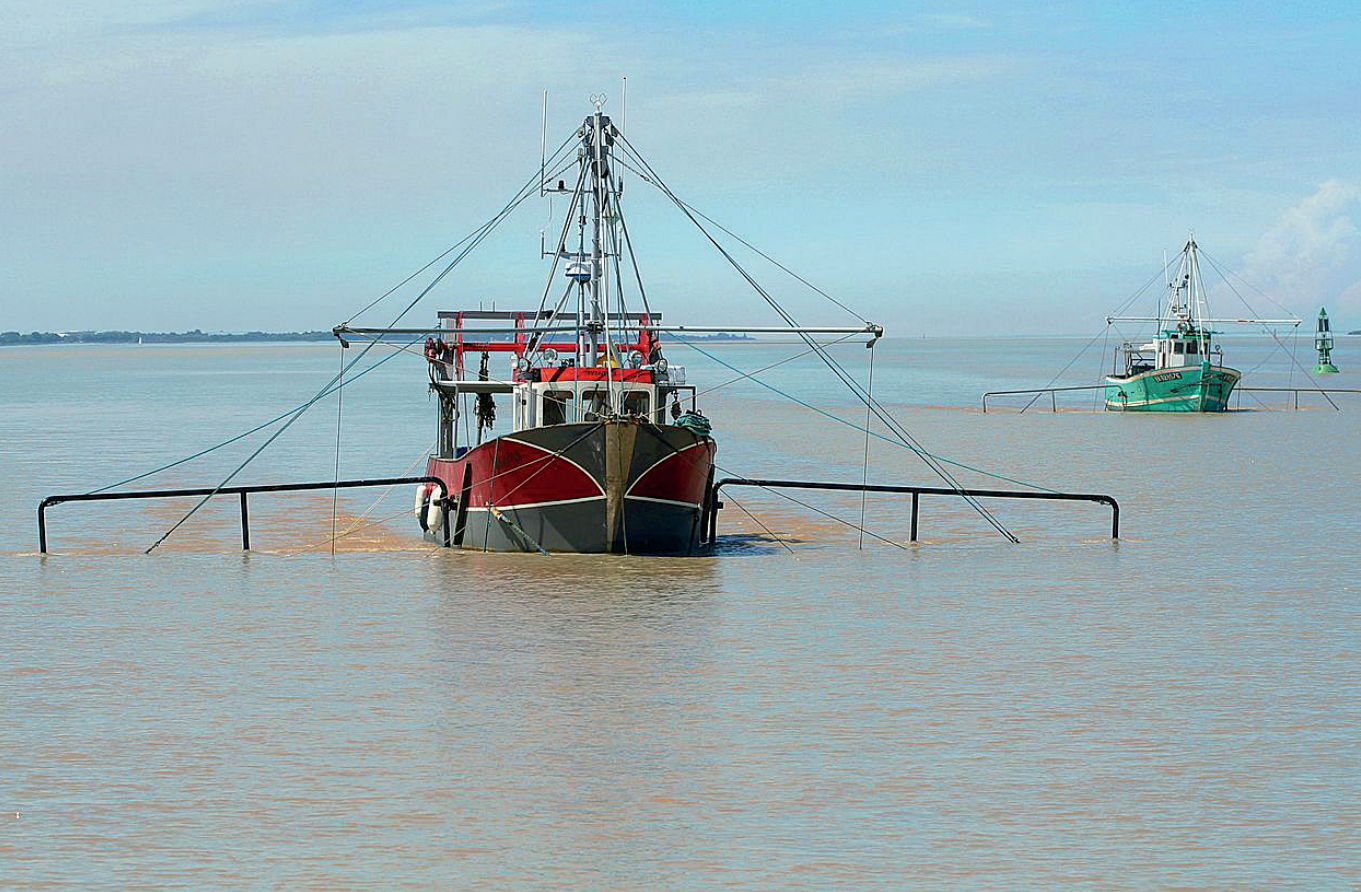
Figure 13 : Navires de pêche à la civelle, équipés de pibalours, dans l'estuaire de la Gironde (Wikimedia commons)
