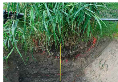
Coupe réalisée sur le fossé F2 du projet « Biotrytis » (p.59), la marque rouge indique le fond du fossé au-dessus duquel se trouvent des dépôts épais (~25 cm) où les rhizomes se sont concentrés.
