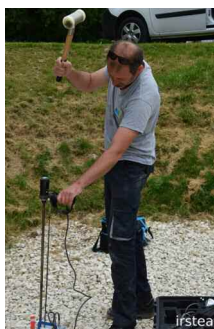
Mise en œuvre d'un pénétromètre à battage manuel.
