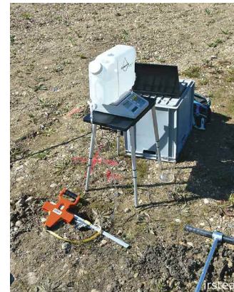
Réalisation d'un essai d'infiltration à l'aide d'un perméamètre à charge constante.
