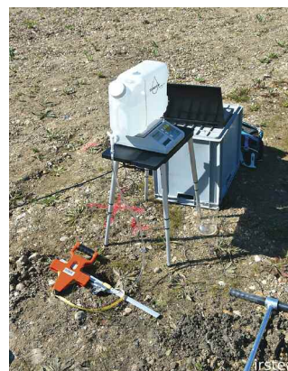
Réalisation d'un essai d'infiltration à l'aide d'un perméamètre à charge constante.
