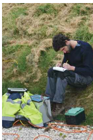
Mesure en cours à l'aide d'un résistivimètre.
