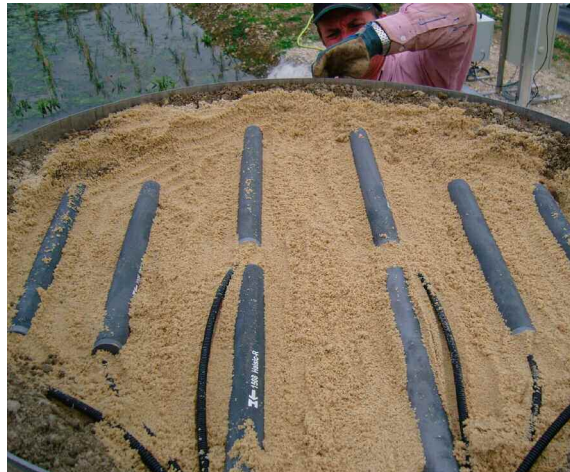
Photo 3. Réseau de bougies poreuses en carbure de silicium disposées au fond de chaque lysimètre pour leur drainage.
