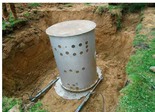
Photo 1. Extraction d'un lysimètre (Ars-sur-Formans).
