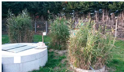
Photo 4. Plateforme lysimétrique en juillet 2016 au début du suivi, après la plantation des roseaux (gauche) ; Plateforme lysimétrique en novembre 2017, après 12 mois de fonctionnement (droite).
