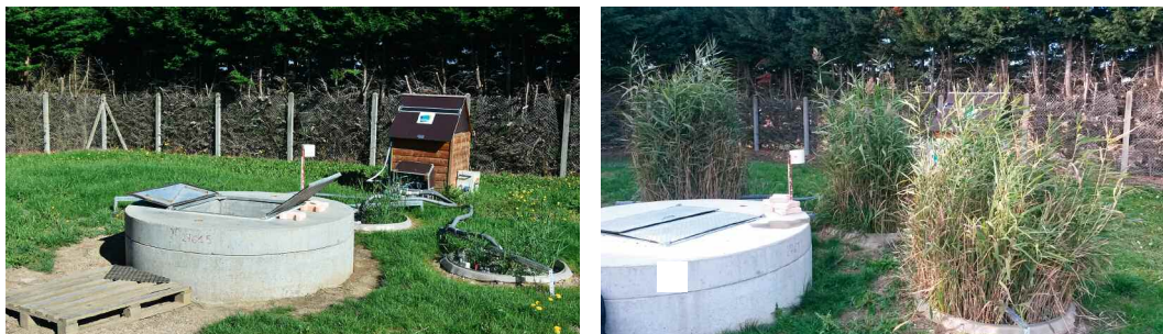
Photo 4. Plateforme lysimétrique en juillet 2016 au début du suivi, après la plantation des roseaux (gauche) ; Plateforme lysimétrique en novembre 2017, après 12 mois de fonctionnement (droite).
