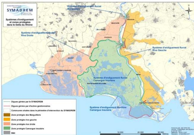
FIGURE 1 : SYSTEMES D'ENDIGUEMENT DANS LE DELTA DU RHONE
