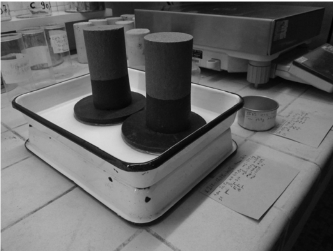
FIGURE 7 : DEUX EPROUVETTES 5×10 CM DE SOL DE LA DIGUE DE LA VILLE-AUX-DAMES, COMPACTEES STATIQUEMENT, ET HUMIDIFIEES PAR REMONTEE CAPILLAIRE. LES EPROUVETTES REPOSENT SUR DES PIERRES POREUSES SUR UN FOND D'EAU ET SE SATURENT EN L'ESPACE DE 4 HEURES (IMM).
