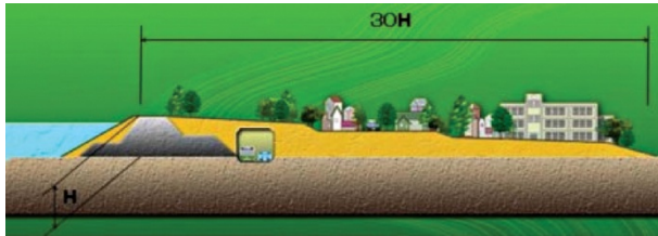
FIGURE 4 : LE CONCEPT DE SUPER DIGUE OU DIGUE MULTIFONCTIONNELLE (DELTA RES)
