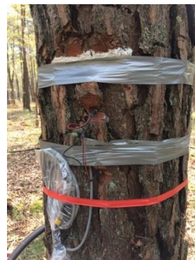
Photo 1.3.1 : Capteur de flux de sève installé sur un Pin sylvestre d'OPTMix
