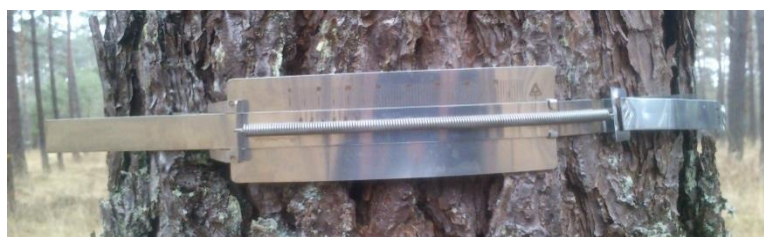
Photo 1.1.1 : Dendromètre à bande installé sur un pin sylvestre en forêt d'Orléans
