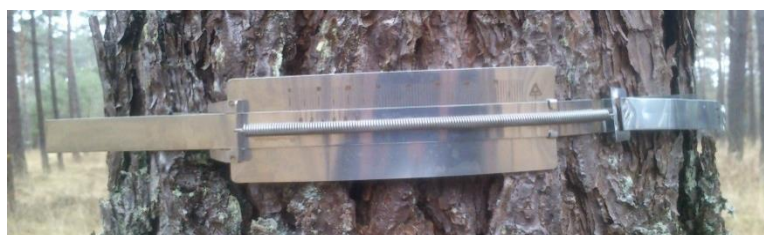
Photo 1.1.1 : Dendromètre à bande installé sur un pin sylvestre en forêt d'Orléans
