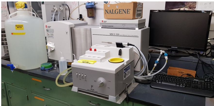
Figure 13: Granulomètre Beckman Coulter utilisé pour les sables en suspension
