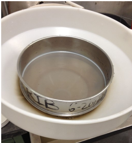
Figure 9 : Tamis placé dans un entonnoir de récupération
