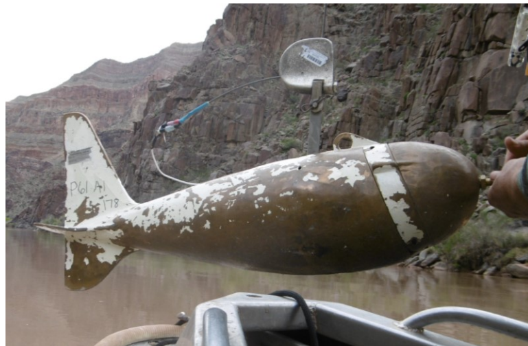
Figure 7 : P61 déployé depuis une nacelle téléphérique sur le Colorado
