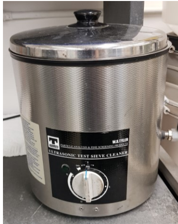
Figure 11 : Cuve à ultrasons utilisée pour nettoyer les tamis
