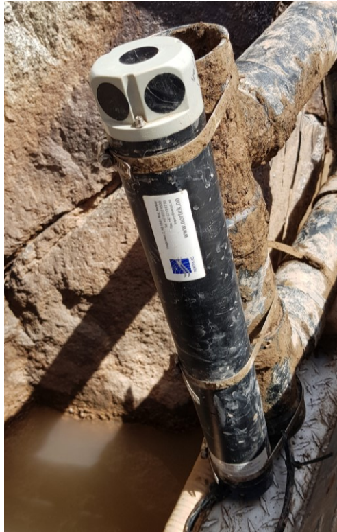
Figure 8: Maintenance d'un ADV à la station de Diamond Creek sur le Colorado
