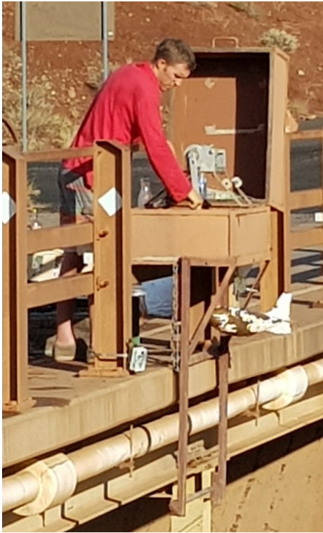
Figure 3: DH74 déployé depuis un pont sur la Paria River (verticale unique). Le matériel reste en place dans une caisse fixée sur la rambarde en amont du pont.
