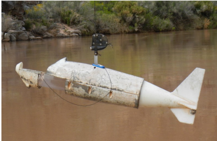
Figure 2 : DH96 déployé depuis un nacelle téléphérique sur le Colorado
