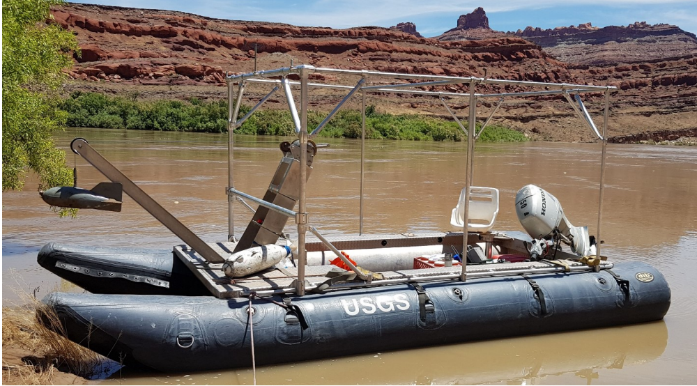
Figure 6: Préleveurs BMH60 (blanc) et BM54 (suspendu au treuil) pour prélèvement d'échantillons de fond, sur catamaran pneumatique utilisé en crue sur le Colorado à Potash.
