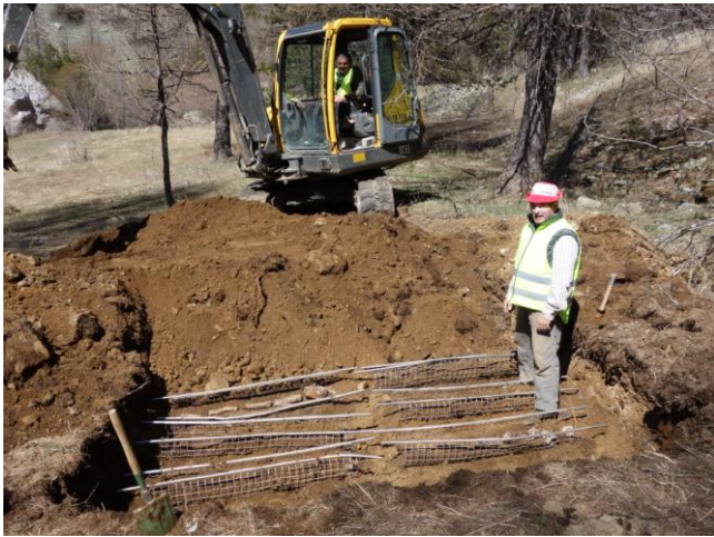
Photos 8 et 9 : l'enfouissement des échantillons restant
