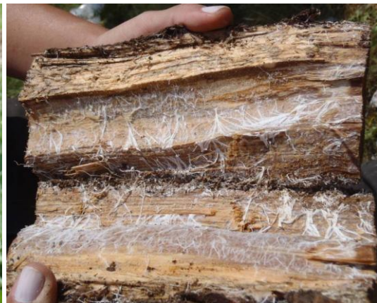
Photo 29 : Champignons blancs développés dans une fente de l'échantillon (produite lors de la découpe en 2009)
