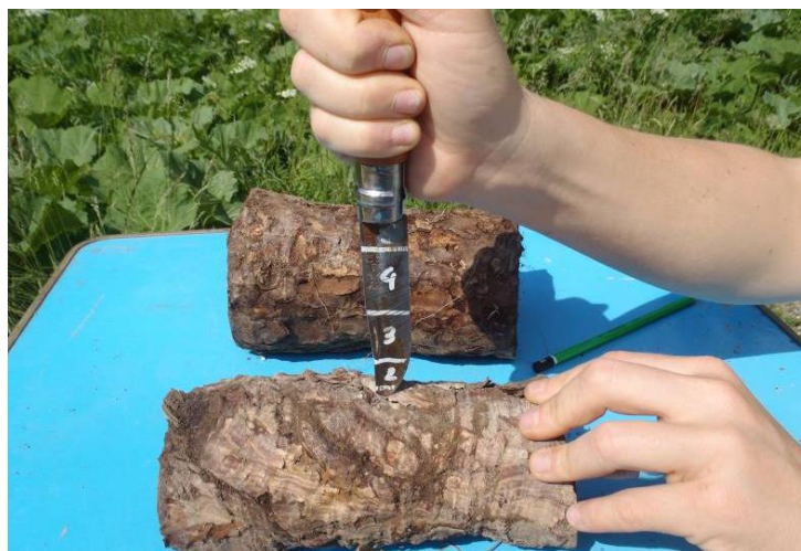
Photo 20 : Test pénétrométrique au couteau (Classe 1 – pénétration de la lame de quelques millimètres)
