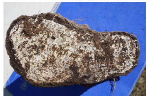
Photo 32 : champignon couvrant une face d'un échantillon de pin sylvestre.
