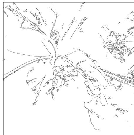
④ Filtre de Canny : On « floute » un peu l'image en niveau de gris ( GaussianBlur ) puis on détecte les contours ( canny ) et on ne garde que les contours verts grâce à l'image HSV ( copyTo ). (3 paramètres)
