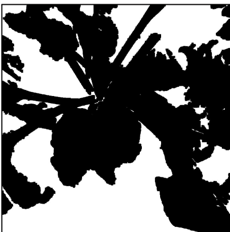
③ Filtre HSV : On convertit l'image RGB en image HSV ( cvtColor ) et on la seuille selon H(30-80), S(0-255) et V(0-255) ( Scalar et inRange ). (7 paramètres)
