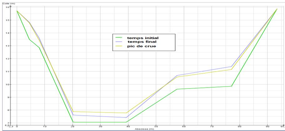
Figure 5. Evolution de la section de PK 35 du lit mineur par le modèle 1D dans le cas d'un couplage (cruée de 1999 sans brèche)
