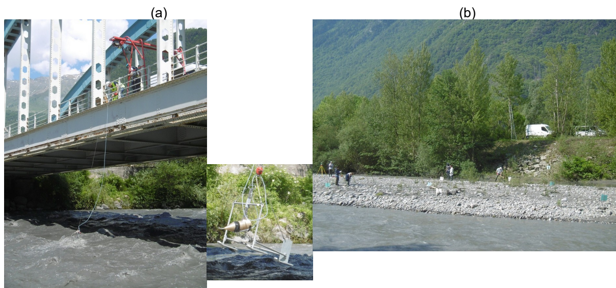
Figure 9 : Photos de l'expérimentation au pont de St-Etienne-de-Cuines avec un zoom sur la structure de la bouteille de Delft avec le système de pompage adapté sur la bouteille (a) et de la manipe de topographie et granulométrie de surface sur la banc de Ste-Marie-de-Cuines (vue de rive droite ; à noter que les appareils photographiques sont positionnés en hauteur sur des arbres légèrement au-dessus de l'échelle).
