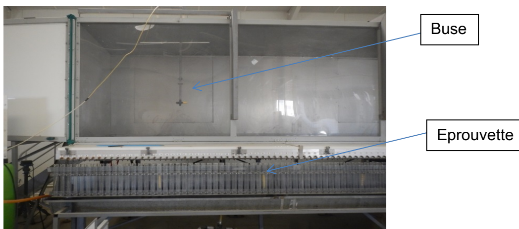
PHOTO 10: VUE D'ENSEMBLE DE LA BUSE EN TEST ET DES EPROUVETTES RECUEILLANT LE LIQUIDE PULVERISE.
