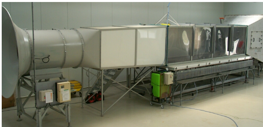
PHOTO 9 : VUE D'ENSEMBLE DU TUNNEL DE DERIVE DE BOIGNEVILLE COMPOSE D'UNE SOUFFLERIE, D'UNE ZONE DE TRANSFERT ET D'UN FILTRE.
