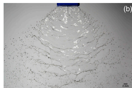
PHOTO 1 : ATOMISATION INDUITE PAR LA PRESSION - BUSE A JET PLAT D'APRES KOOIJ ET AL. (2018).
