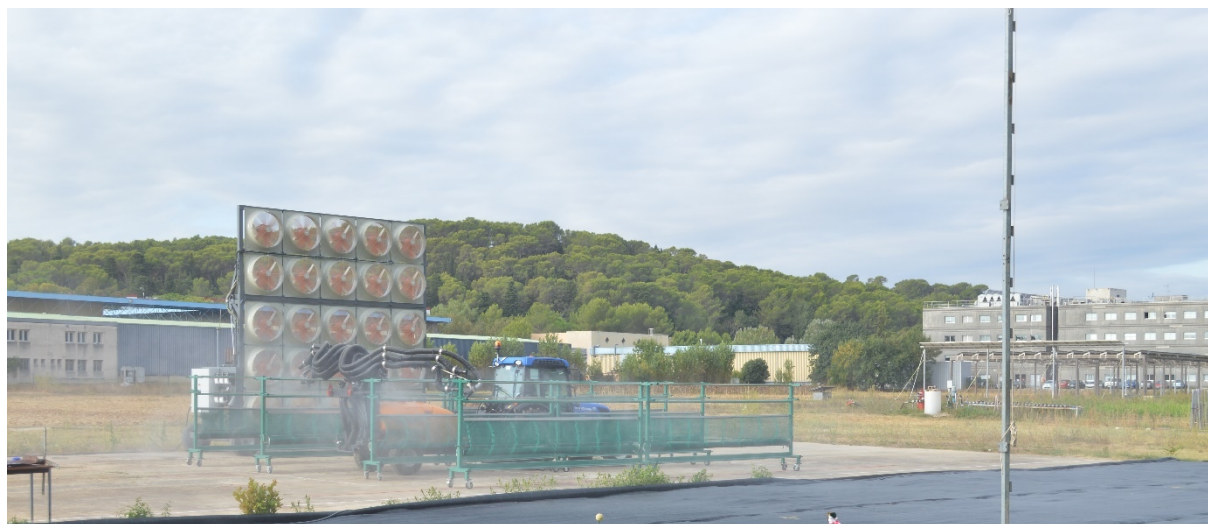
PHOTO 6 : REALISATION DES PREMIERS ESSAIS DE MESURE DE LA DERIVE SUR EOLEDRIFT - UTILISATION DU BANC EN DEBUT DE VEGETATION.
