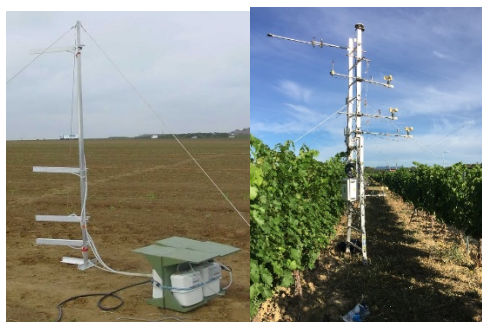
PHOTO 13 : MESURES AU CHAMP : (GAUCHE) SYSTEMES DE PRELEVEMENTS D'AIR, (DROITE) MAT MICROMETEOROLOGIQUE
