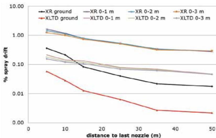
**FIGURE 1** : COMPARAISON DE BUSES SELON LES PROTOCOLES SEDIMENTAIRES ET AERIENS XR : BUSE A JET PLAT STANDARD ; XLTD : BUSE A JET PLAT ANTIDERIVE. LES MESURES AERIENNES SONT DETAILLEES POUR DES PLAGES DE HAUTEUR (0-1M ; 0-2M ; 0-3M) (ETUDE OBO : [HTTPS://WWW.BESTRIJDINGSMIDDELEN-OMWONENDEN.NL/ENGLISH](https://www.bestrijdingsmiddelen-omwonenden.nl/english)).
