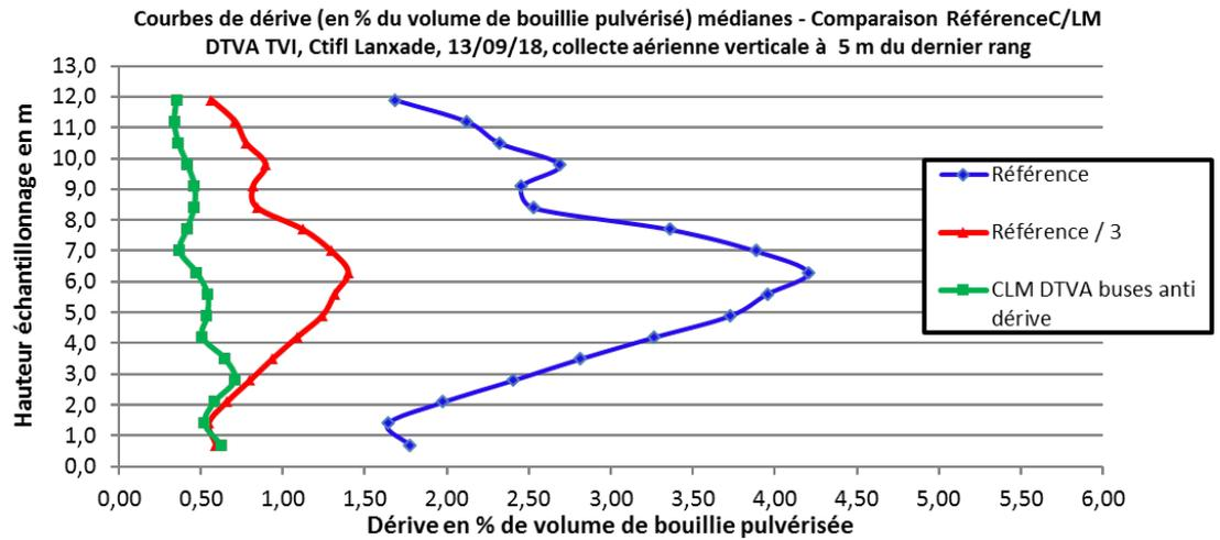
**FIGURE 15 : COURBES DE DERIVE SEDIMENTAIRE ET AERIENNE MESUREES.**
