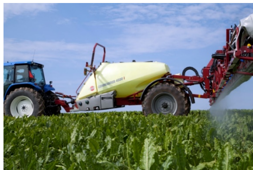
PHOTO 4 : PULVERISATEUR EQUIPE DE L'ASSISTANCE D'AIR « TWIN ». COPYRIGHT : HARDI-EVRARD
