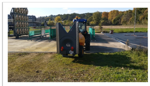
PHOTO 3 : ETUDE DE DERIVE AERIEENNE AVEC VENT ARTIFICIEL PHOTO INRAE.
