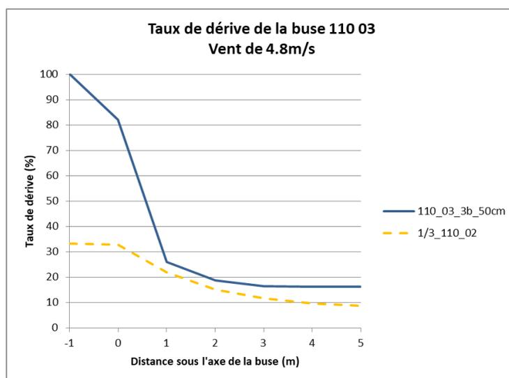
FIGURE 16 : TAUX DE DERIVE D'UNE BUSE 110 03 A 3 BAR ET 50 CM DE HAUT COMPAREE AU 1/3 D'UNE BUSE DE REFERENCE (110 02 A 2,5 BAR).
