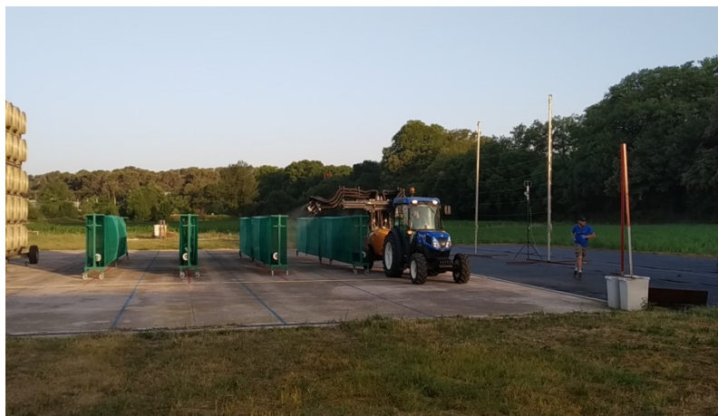
PHOTO 7 : REALISATION DES PREMIERS ESSAIS DE MESURE DE LA DERIVE SUR EOLEDRIFT - UTILISATION DU BANC SUR UN STADE DE PLEINE VEGETATION.
