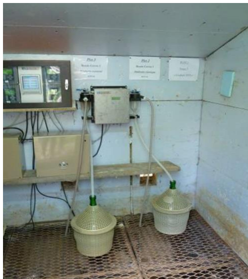
Photo 4 : équipement de mesure des débits et prélèvement des échantillons d'eau du réseau de drainage ; EPLEA Courcelles-Chaussy (57)
