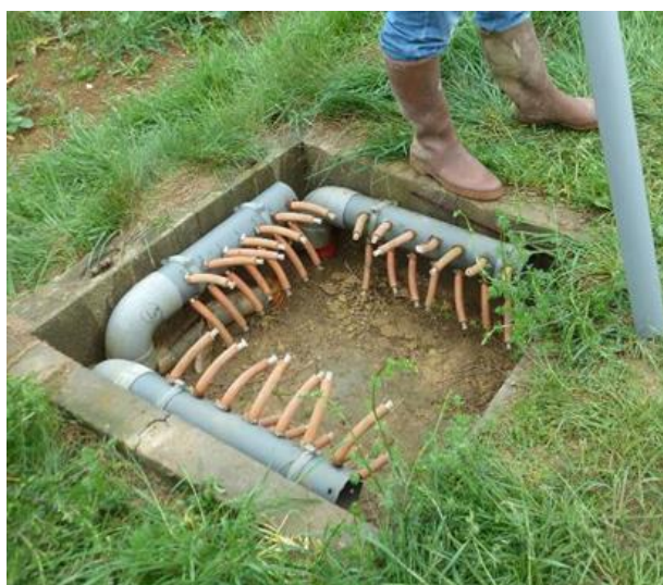
Photo 3 : site à bougies poreuses, sortie des capillaires de prélèvements des eaux en bordure de parcelle (Villey-saint-Etienne, 54) ; CRAL
