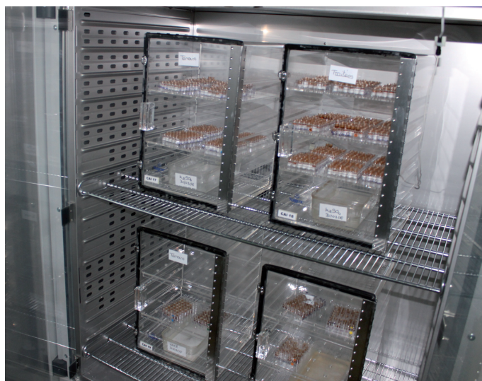
Figure 4. Étuve et caissons d'élevage (photo : INRA).
