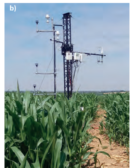
Figure 2. (a) Épandage de fumier sur le champ cultivé qui constitue le site d'observation à long terme Icos (Integrated Carbon Observing System) de l'unité de recherche Inra-AgroParisTech du centre de Versailles-Grignon. (b) Instrumentation permettant le suivi des émissions de gaz à effet de serre et de (précurseurs de) polluants atmosphériques sur le site. Ce site est équipé depuis 2004 et permet, en collaboration avec la ferme d'AgroParisTech à Grignon, de documenter et quantifier les liens entre ces émissions et les pratiques agricoles en conditions réelles.
