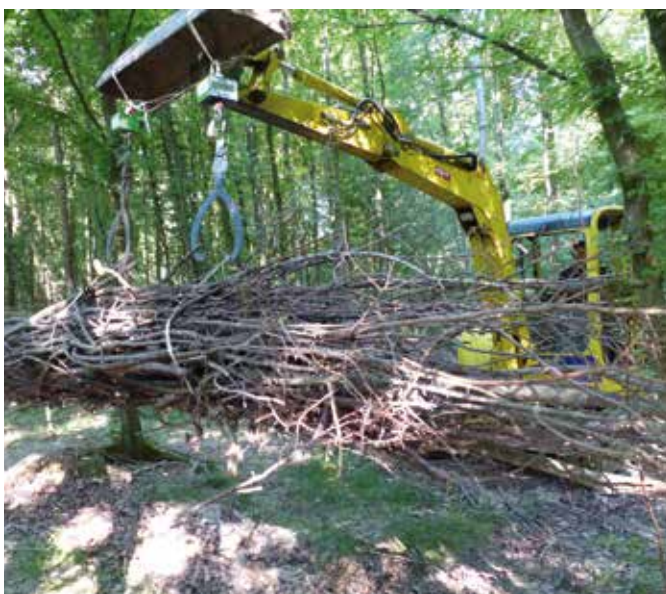
Fig. 5 : pesée d'un fagot à l'aide d'un peson fixé au bras de la pelleteuse
